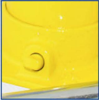
Valvula de paso que permite el fluido hidráulico en una sola dirección; cerrado para levantar, abierto para bajar.
