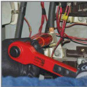
La herramienta aislada URREA está diseñada y certificada para trabajar con toda seguridad en actividades y operaciones donde hay riesgo de contacto con partes eléctricas vivas de hasta 1000V (CA) ó 1500V (CD).
