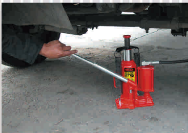
Operación neumática o manual (según preferencia) Equipado con válvula de seguridad
